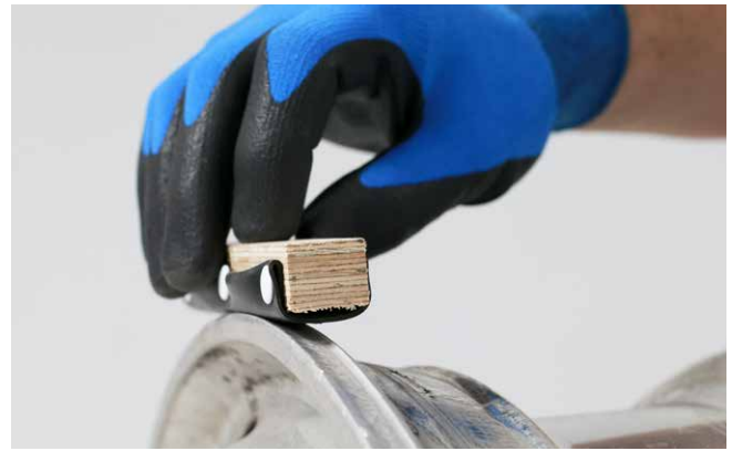
Kuva 1: Vanteen kantin kumitesti
