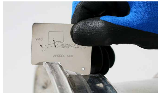
Kuva 4: Huolletun vanteen tarkistus mittalevyn avulla
